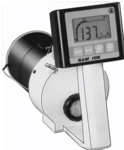
Figura 6.7 - Câmara de ionização, portátil, tipo “babyline”, com faixa de medição de 0,1 \text{ mR/h} a 50 \text{ R/h} ( 1 \text{ } \mu\text{Sv/h} a 500 \text{ mSv/h} ), para detecção de radiações X, gama e beta, em instalações nucleares, clínicas de medicina nuclear, radiodiagnóstico e radioterapia.
