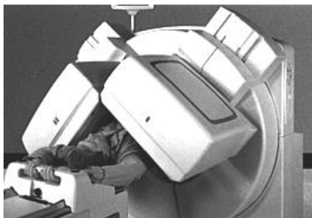
Figura 6.21 - Gama-Câmara de duas cabeças, com detector de NaI(Tl) planar de grandes dimensões, utilizado em diagnóstico com radiofármacos em órgãos e corpo inteiro, em medicina nuclear.
