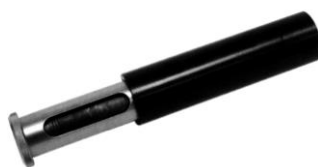
Figura 6.16 - Sonda G-M para detecção beta e gama, com janela metálica muito fina.
