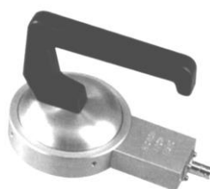
Figura 6.15 - Detector Geiger, tipo pancake, para medição de contaminação superficial com janela de mylar aluminizado, para radiação alfa, beta e gama.
