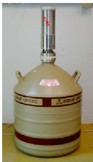
Figura 6.30 - Detector de germânio de alta pureza, modelo axial, resfriado a nitrogênio líquido, utilizado em técnicas de espectrometria X e gama, em medições de laboratório.
