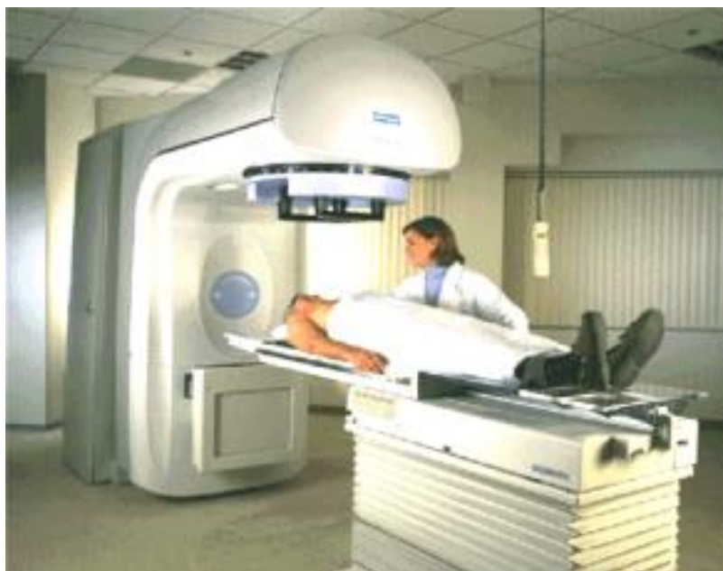
Figura 2.11b - Acelerador de elétrons usado em terapia de câncer em hospitais.
