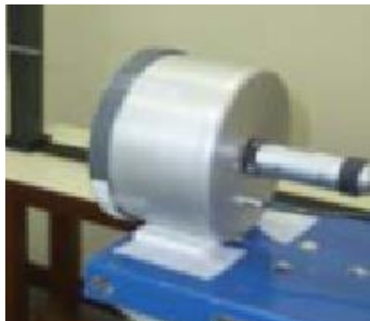
Figura 6.10 - Câmara de extrapolação modelo PTW 23391.
