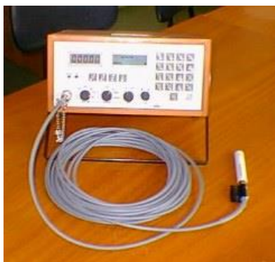
Figura 6.11 - Dosímetro Farmer modelo 2570 A, da Nuclear Enterprise.
